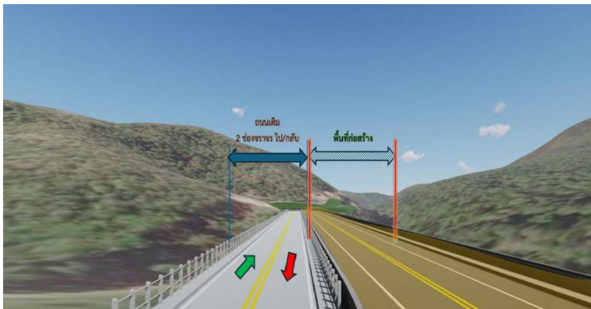
รูปที่ 6.2-15 การจัดจราจรระหว่างก่อสร้างของโครงการ บริเวณช่วงสะพาน (ต่อ)
