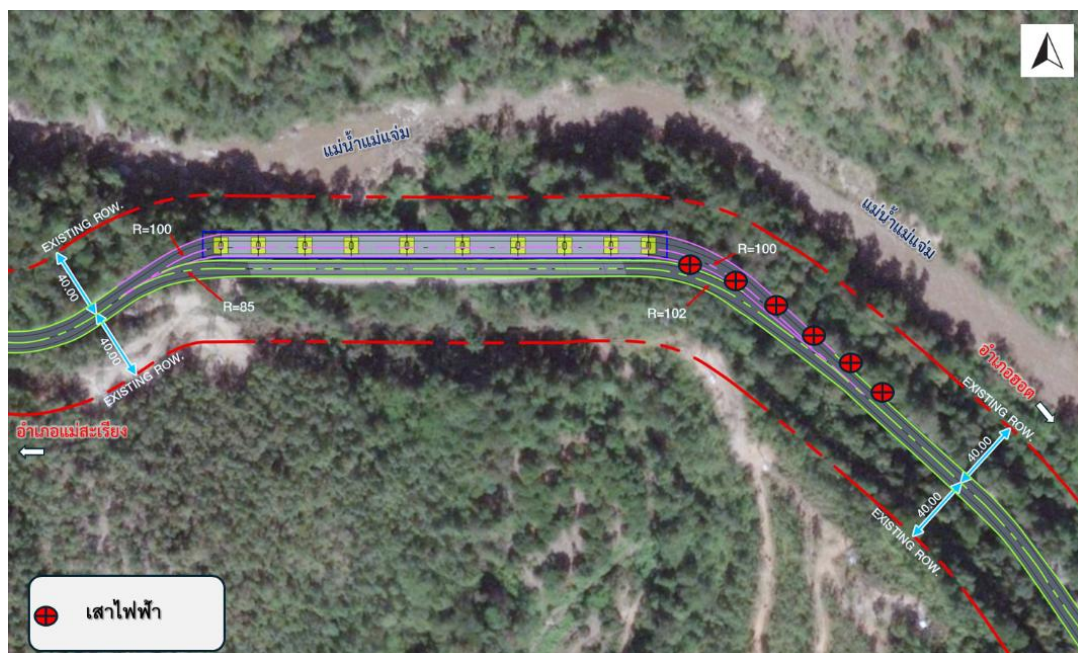
รูปที่ 5-12 เสาไฟฟ้าบริเวณพื้นที่โครงการที่ต้องรื้อย้าย
